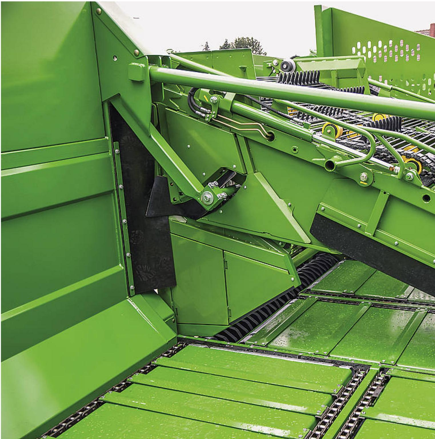
Der Längs- und auch der Quertransportboden sind mit speziell geformten, äußerst rübenschonenden Mitnehmern ausgestattet.
