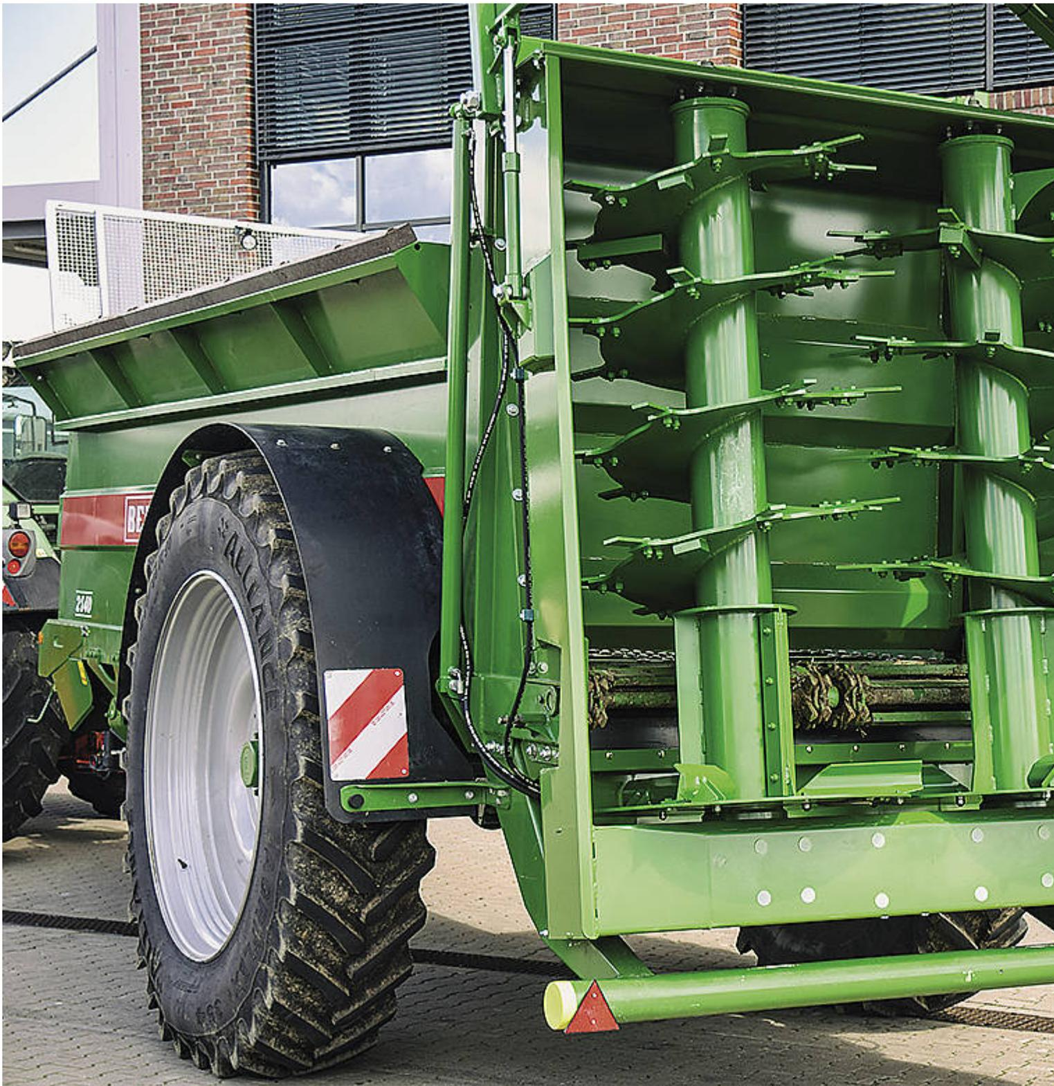
Das neue 2-Walzen-Streuwerk 2 Spread mit den Streuwalzen mit 1050 mm Durchmesser und den Streutellern mit Wurfschaufeln
