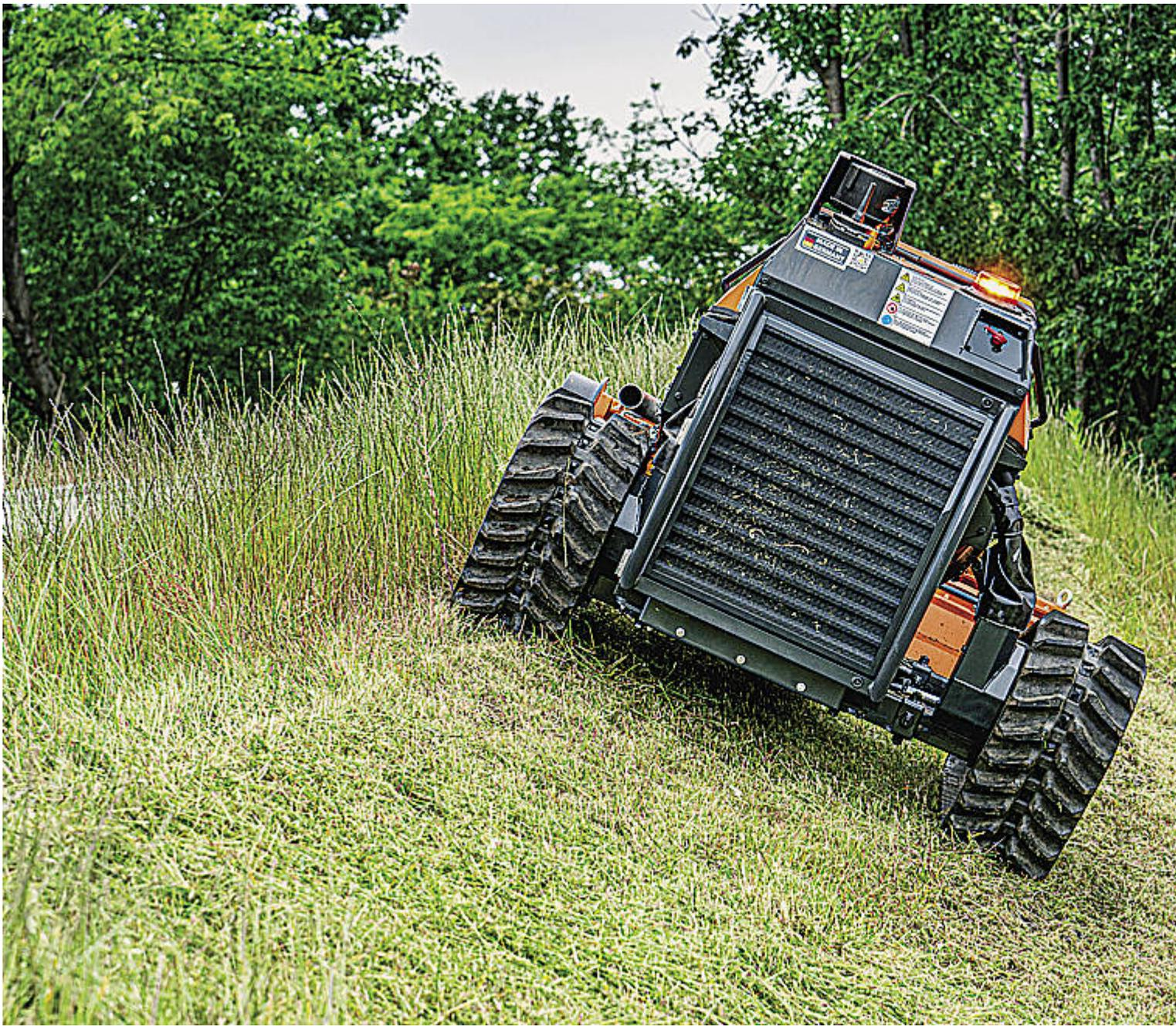
Das Raupenfahrwerk lässt sich beidseitig auf eine Gesamtbreite von bis zu 1,85 Metern ausfahren.
