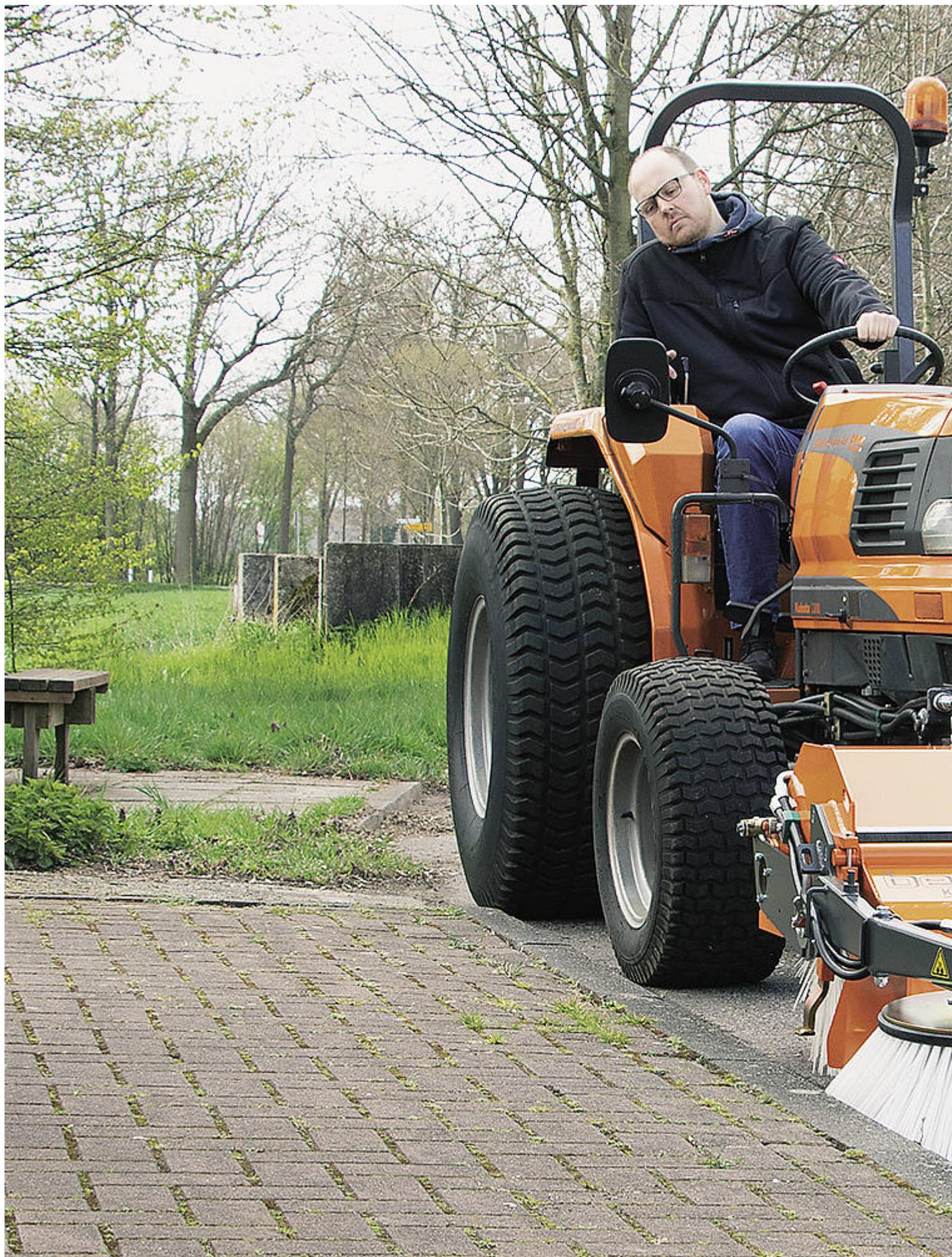
Die neuen Kehrmaschinenmodelle sind für den kommunalen Einsatz konzipiert und mit 450 und 580 mm Durchmesser erhältlich. Sonderausrüstungen ergänzen das Einsatzspektrum.
