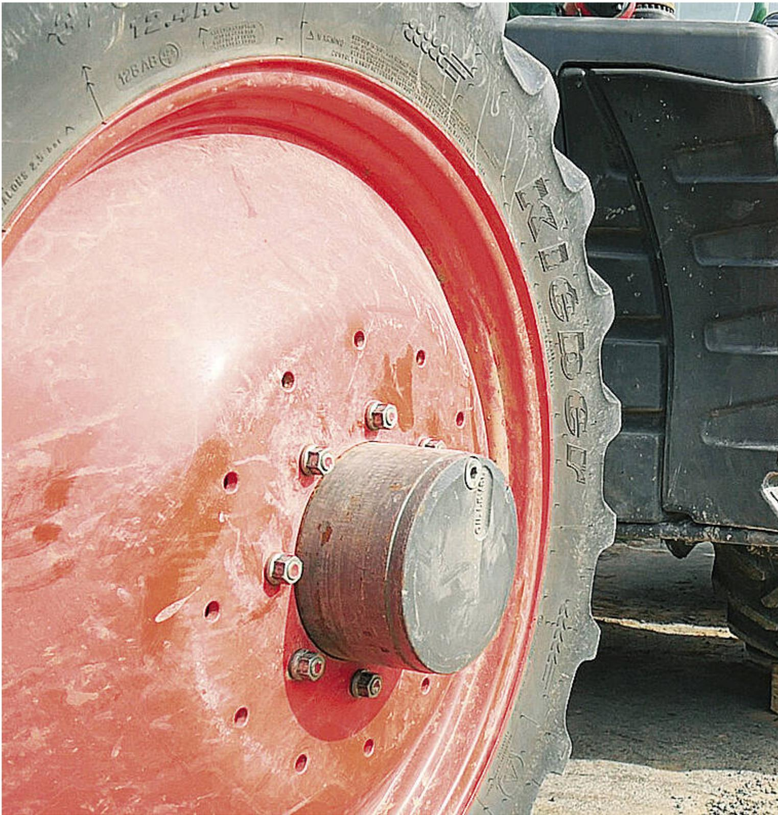
Für das Aus- und Einfahren des Doppelrads wird auf einen Holzkeil gefahren.
