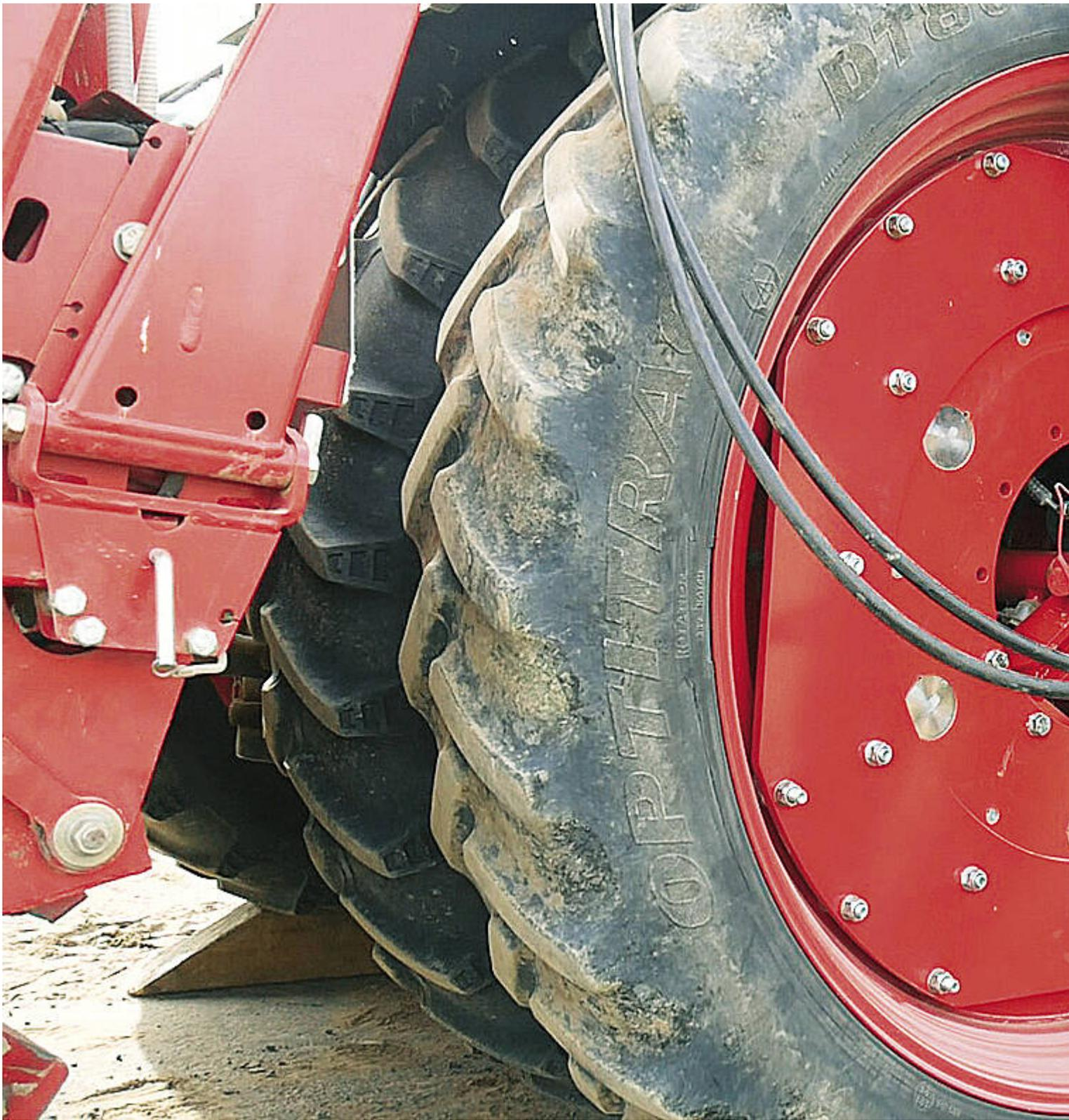
Von der Bordhydraulik des Traktors werden zwei Schläuche für den Verschiebevorgang angeschlossen.
