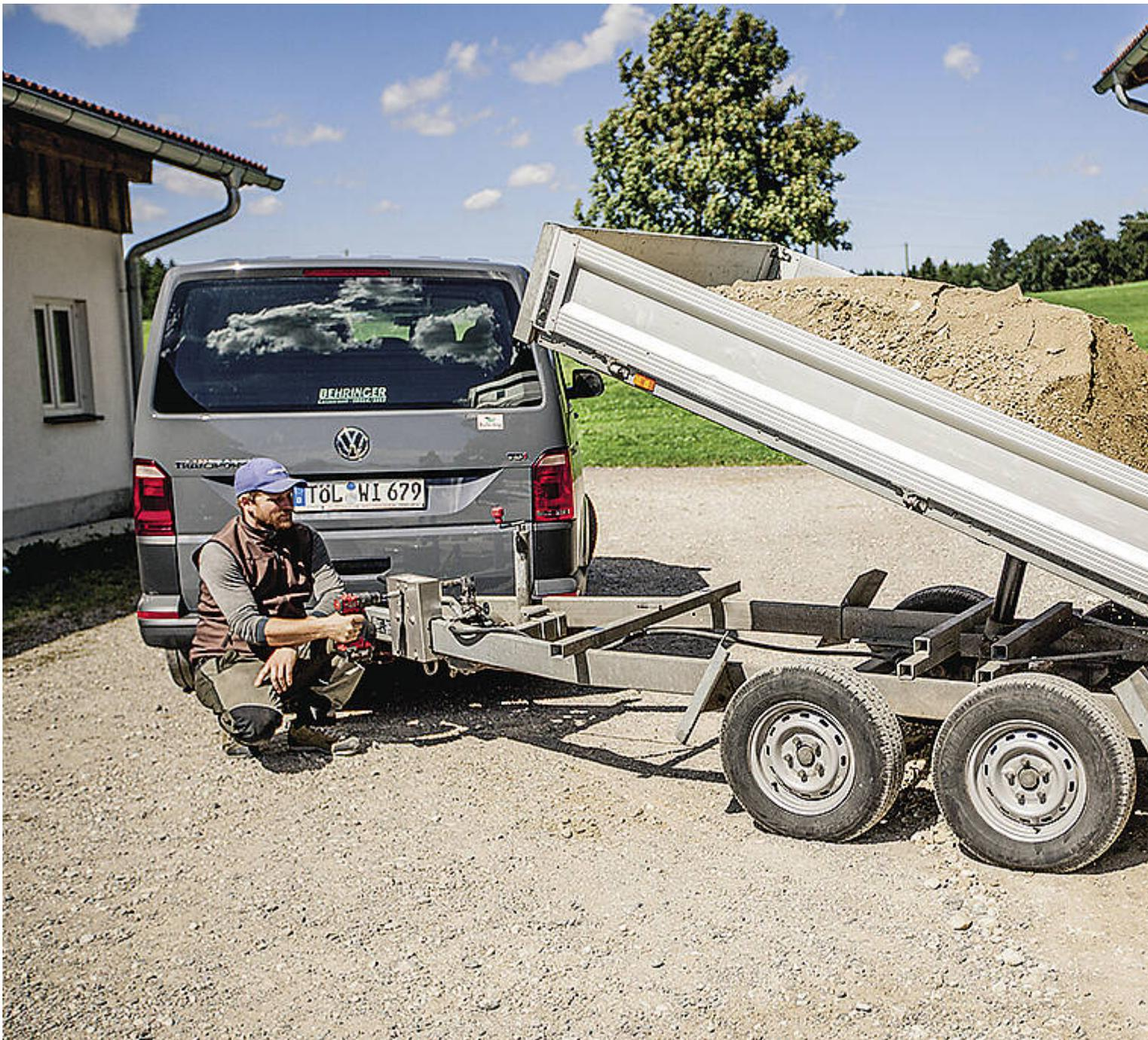
Wer einen Kipper am Pkw nutzt, kann durch den PumpFast die Hydraulikhebelelei an den Akkuschauber delegieren.
