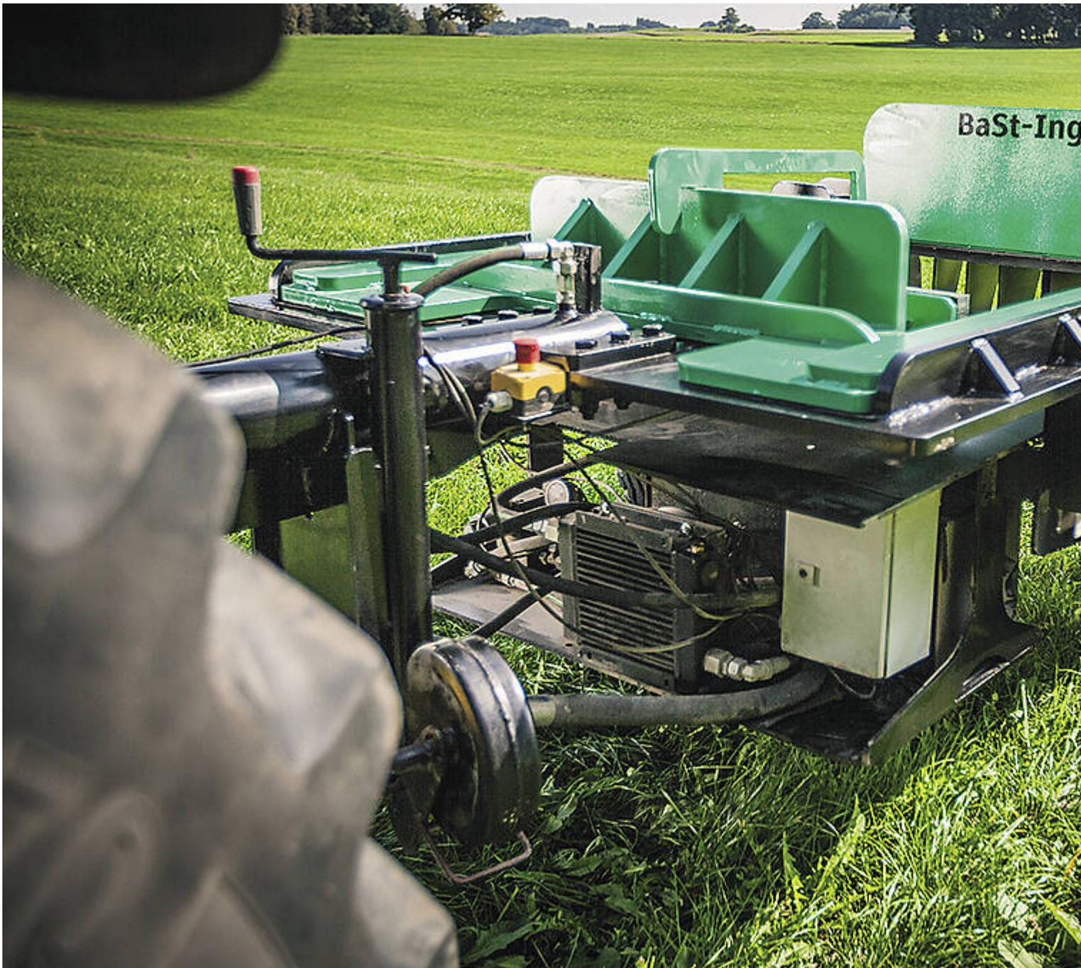
Der SpaltFast kann von kleineren Traktoren mit 40 bis 50 PS betrieben werden.
