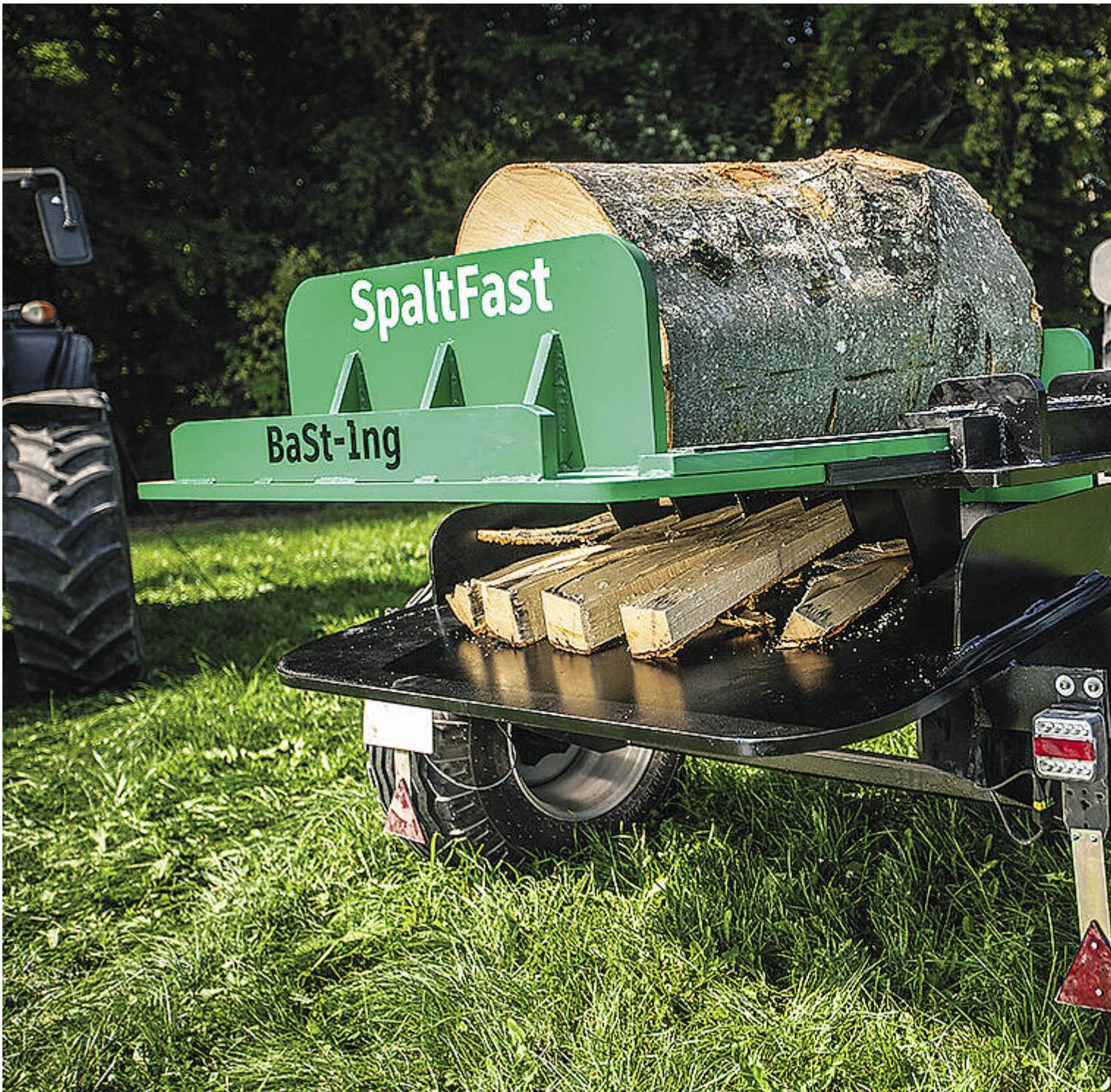
Der innovative SpaltFast Schichtholzspalter verarbeitet Rundlinge schichtweise von außen direkt in stapelbare Ein-Meter-Scheite
