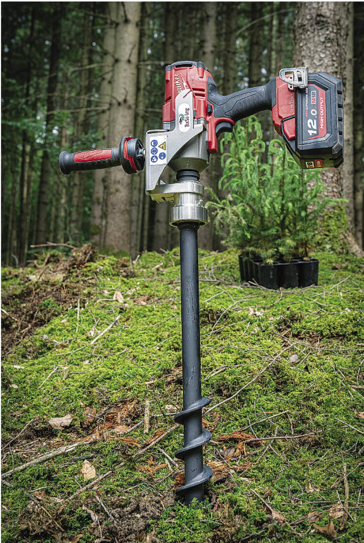
Der per Akkuschauber angetriebene Erdbohrer DrillFast lockert die Erde statt sie zu verdichten wie bei einem Spaten. Das freue laut BaSt-Ing vor allem junge Wurzeln beim Einpflanzen.
