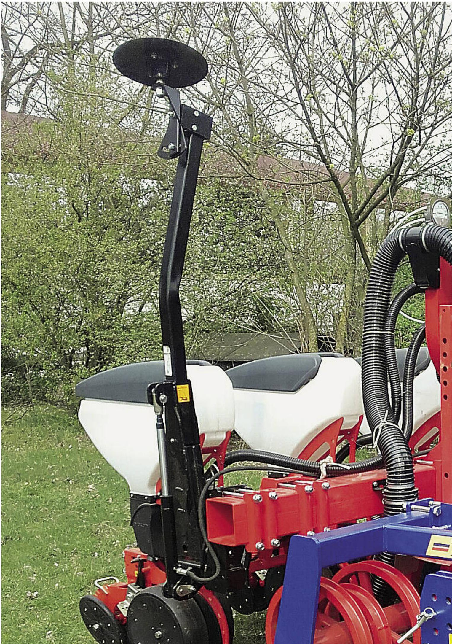
Die Maschine für den Dammanbau übernimmt Lockern, Dammformen, Rückverfestigen des Damms und Saatgutablage.
