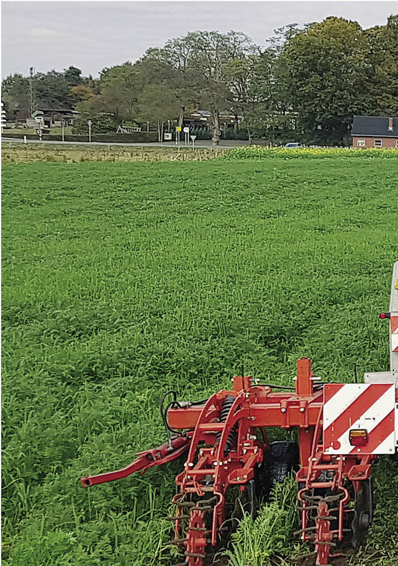
Bodendruckversuche mit einem vom Hante-Team modifizierten Striger, bei dem alle Strip-Till-Aggregate in Fahrtrichtung betrachtet um 37,5 cm nach rechts verschoben wurden.
