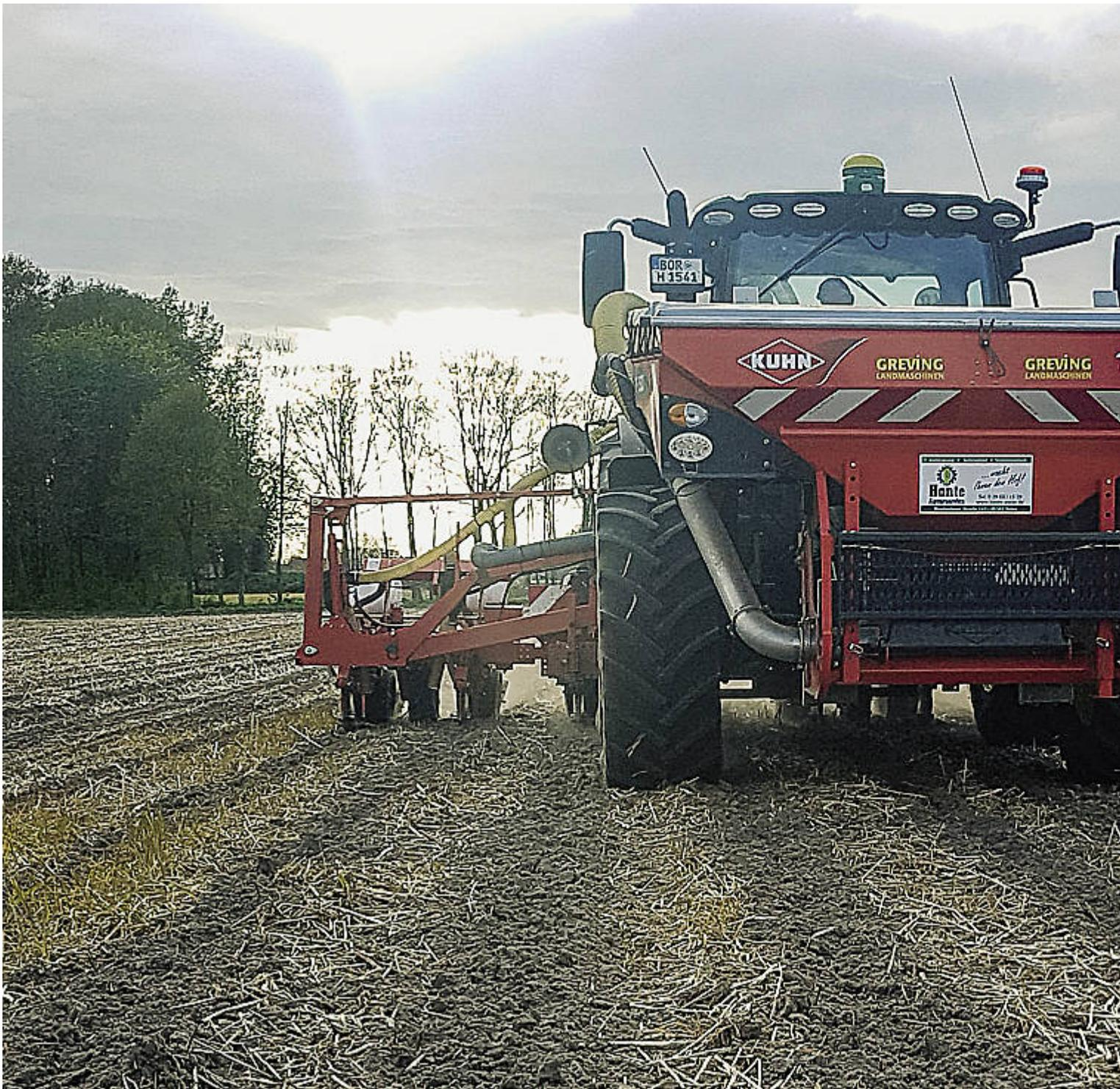
Das Einzelkornsäegerät nach der Strip-Till-Anwendung ist seitlich versetzt angeordnet, damit die Traktorräder zwischen den Lock
