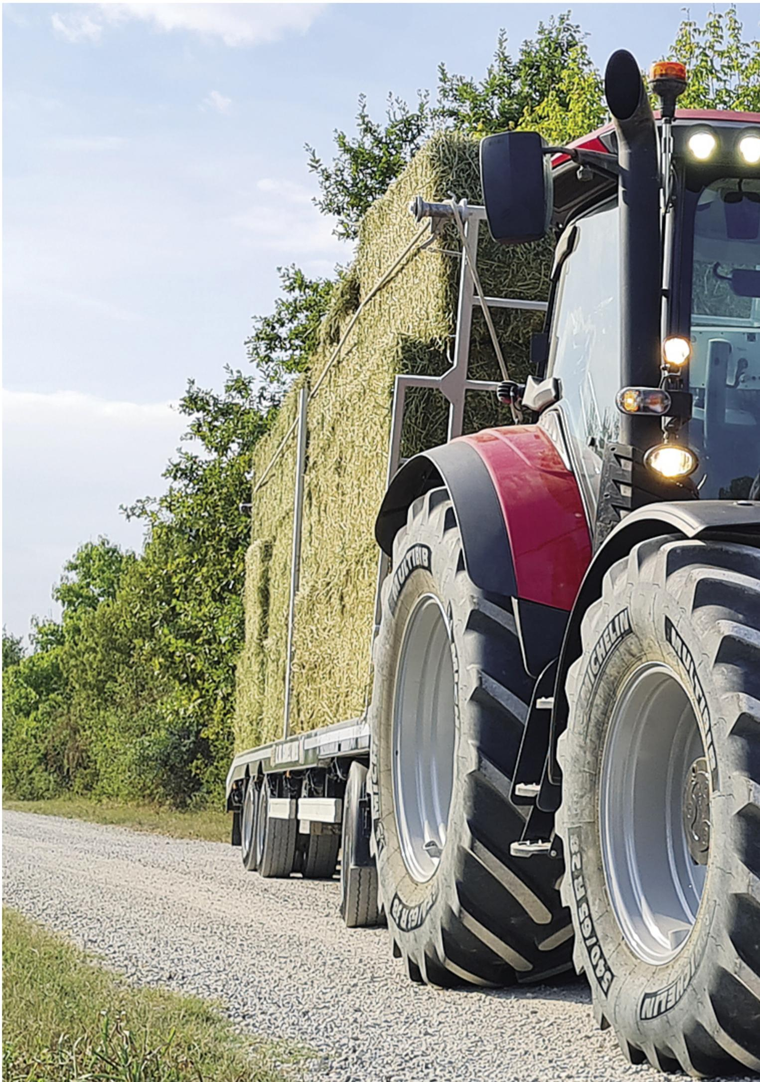
Die Modelle der Baureihe X7 sind mit bis zu 175 PS ausgestattet und entsprechen der Stage V Norm.
