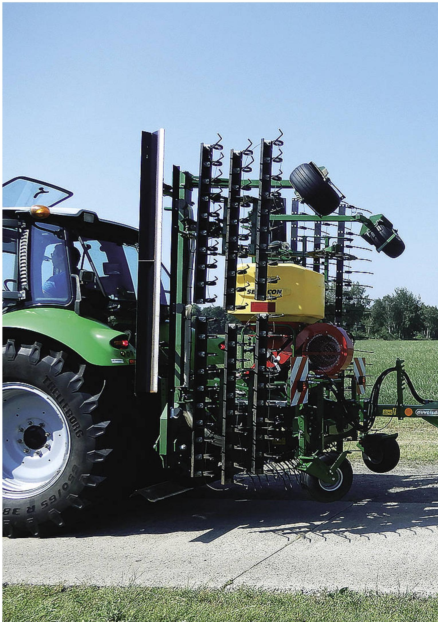
Hinter einem Anbaugerät kann auch ein angehängtes Arbeitsgerät mitgeführt werden. Es darf nicht schneller als 25 km/h gefahren werden.
