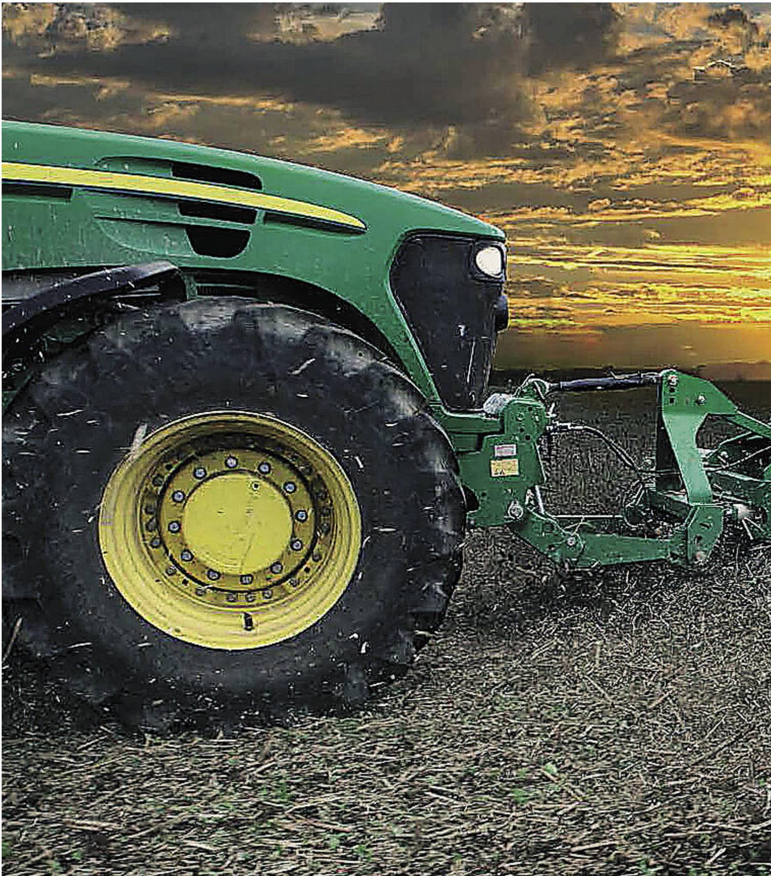
Der Kverner X-Cut zerkleinert Vorfruchtreste, er kann sowohl im Front- als auch im Heckhubwerk gefahren werden.
