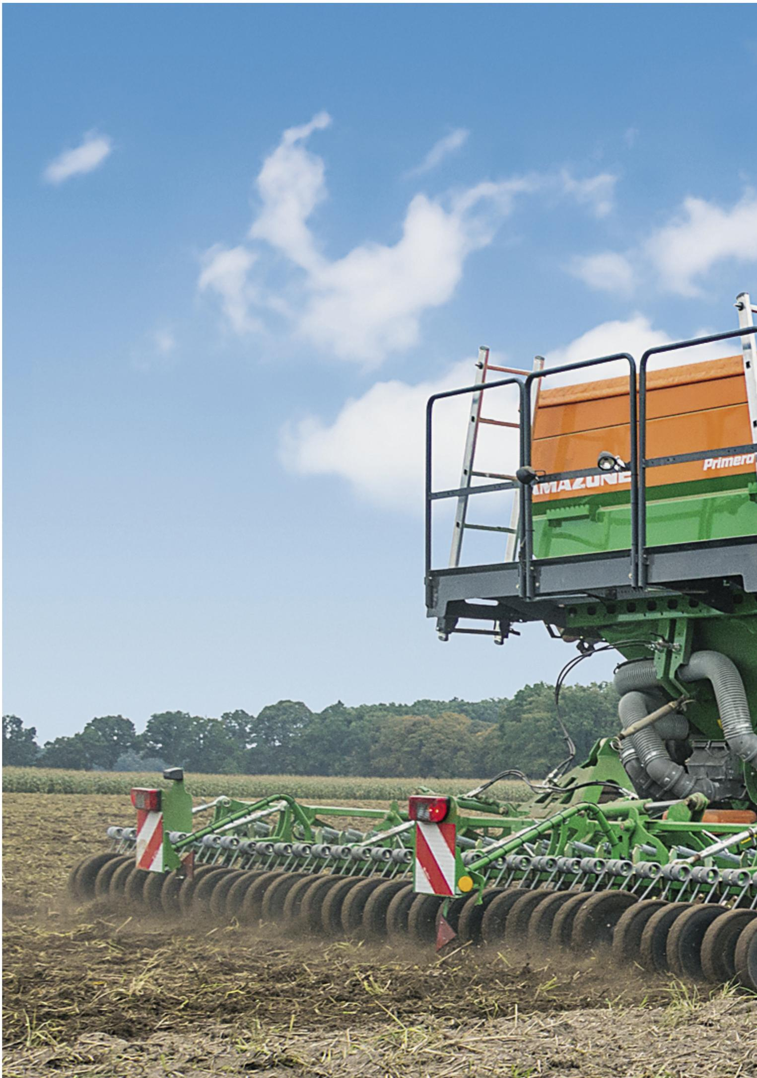
Die Amazone Primera DMC muss durch Mulch und Stoppel, Wurzeln und harten, ungelockerten Boden dringen können.
