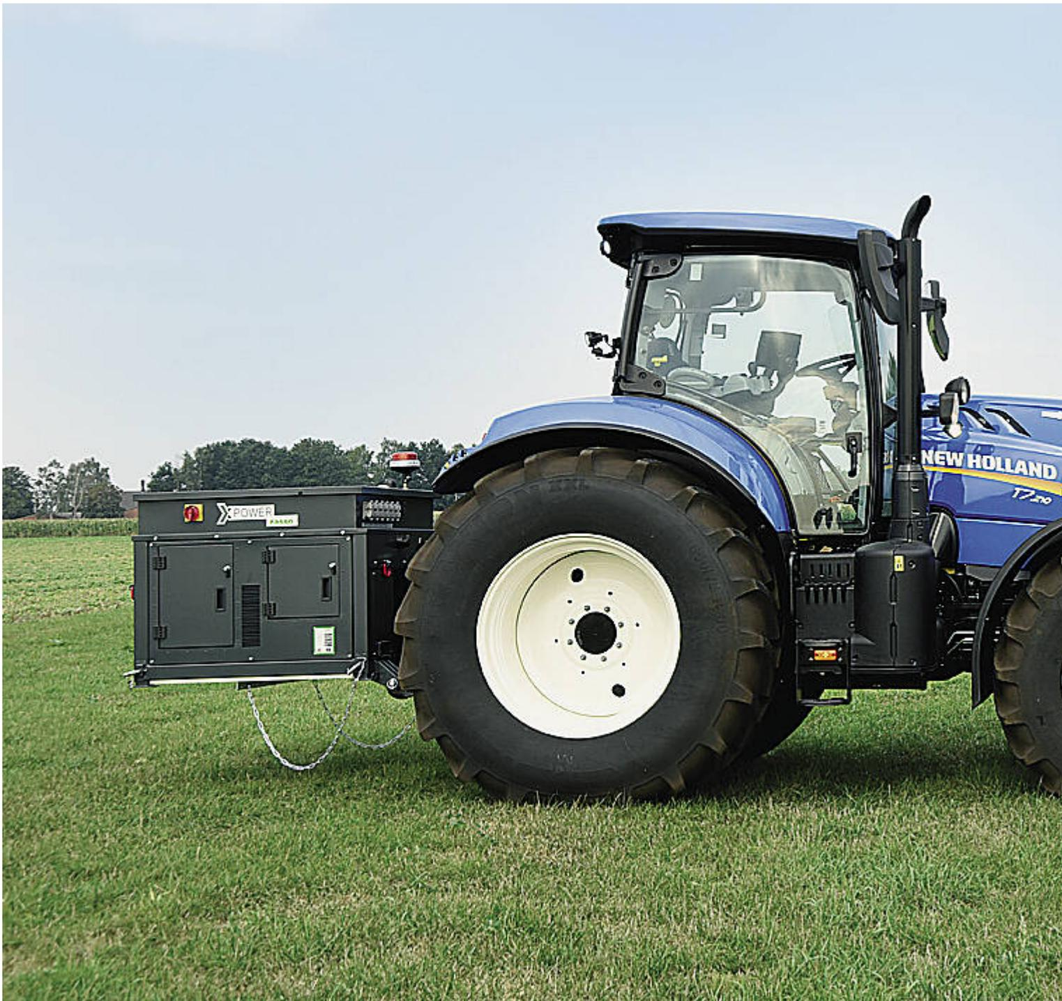
Der inzwischen serienreife XPower bekämpft Unkraut mit Strom, den ein Generator im Heck erzeugt.
