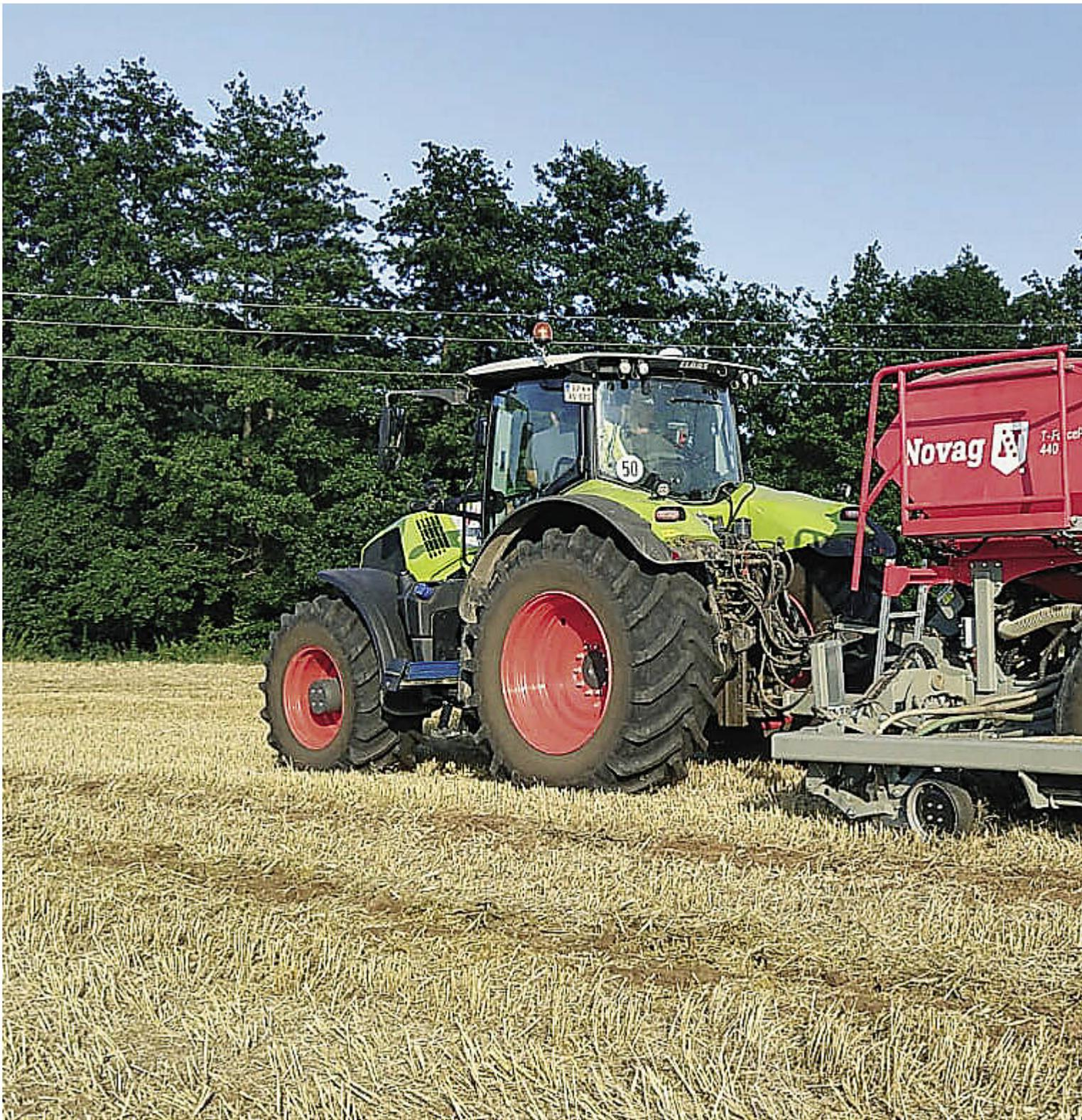
Die Novag T-Force arbeitet von 2,85 bis 9 m Breite und wiegt dabei zwischen 6,5 und 20 t, der Schardruck beträgt bis 500 kg.
