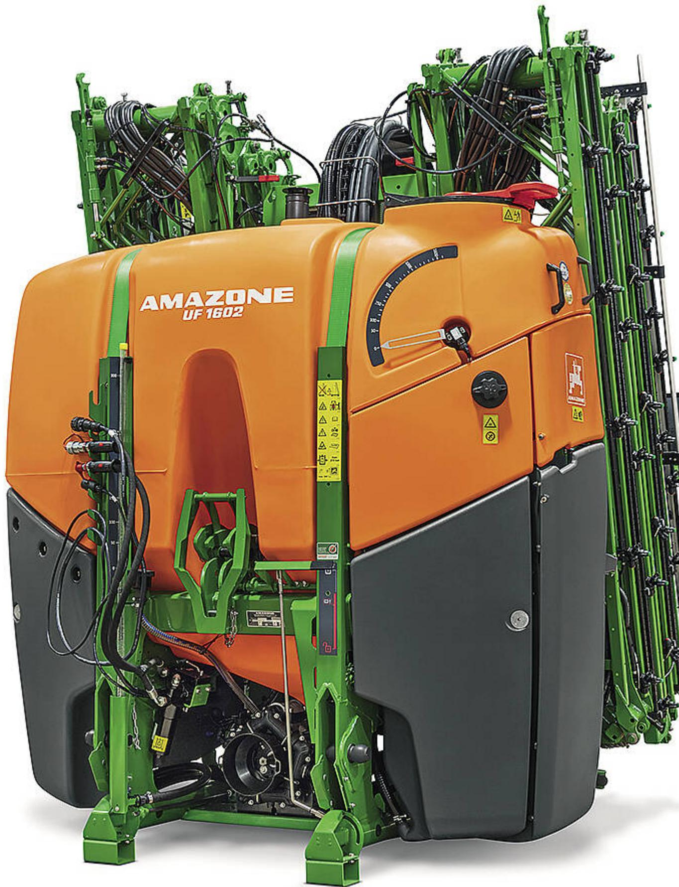
Die Amazone Anbauspritze UF 1602 mit der speziellen, konischen Behälterform.
