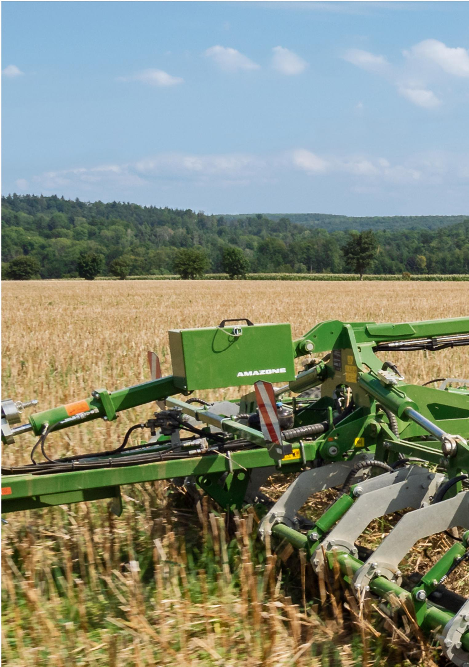
Der neue Anhängelflachgrubber Cobra-2TX von Amazone in der flachen Stoppelbearbeitung.
