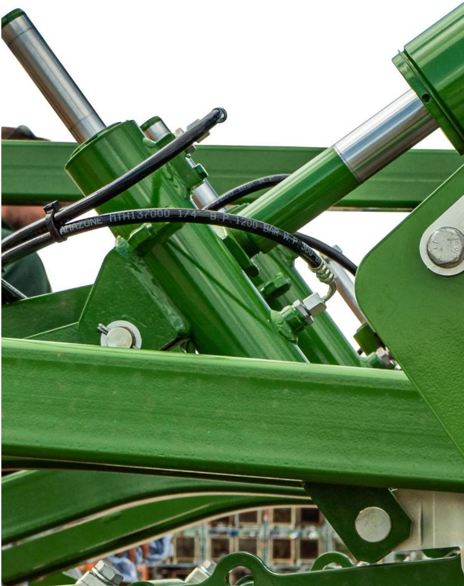
Die hohe Auslösekraft von bis zu 800 kg sorgt für eine gleichbleibende Arbeitstiefe und schützt den Rahmen.
