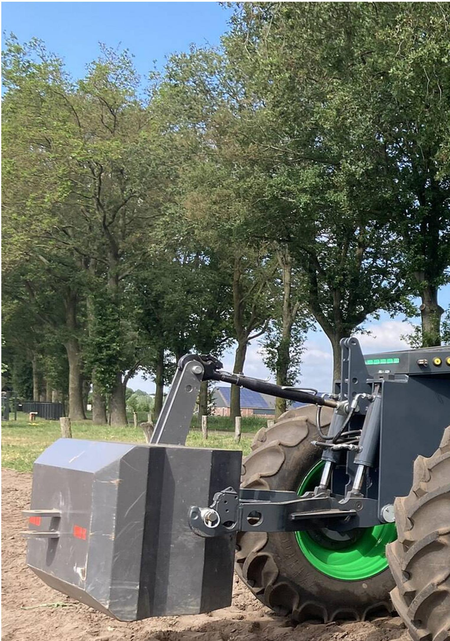
Für die Kopplung der Anbaugeräte, verfügt der AgBot über einen Standard Kat. 2 Frontkraftheber mit einer Hubkraft von 1,5 t und einen Kat. 3 Heckkraftheber mit einer Hubkraft von 4 t.
