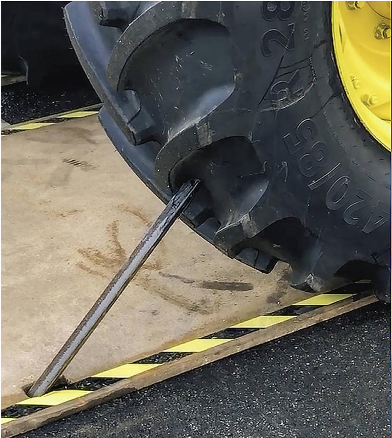
Ein Polymer dichtet von innen den Reifen ab. Das Fahrzeug kann weitergefahren werden, der Reifen wird später repariert.
