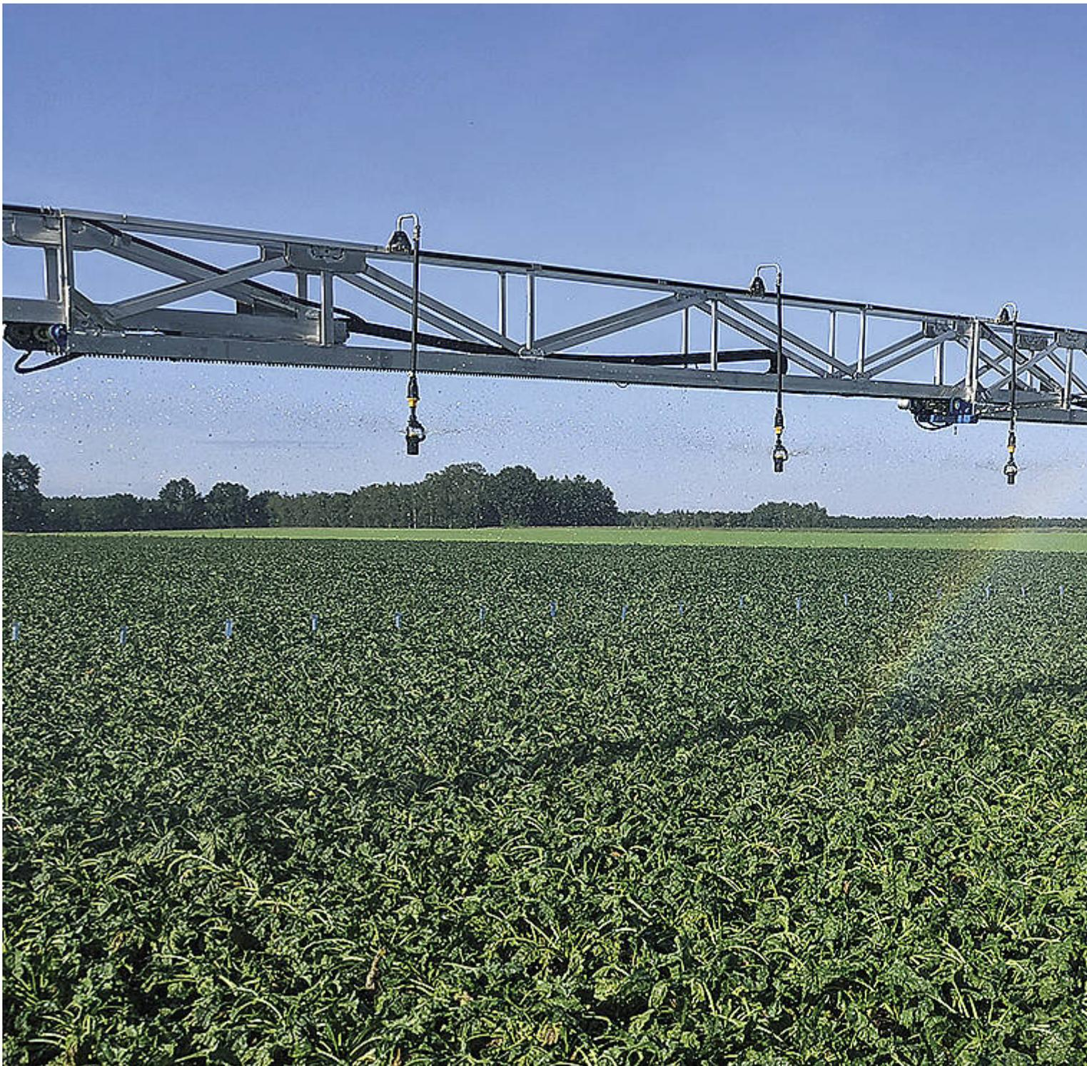
DL 66 Pro: Energiesparende Kombination aus mobiler Beregnungsmaschine und einem Düsenschlitten.
